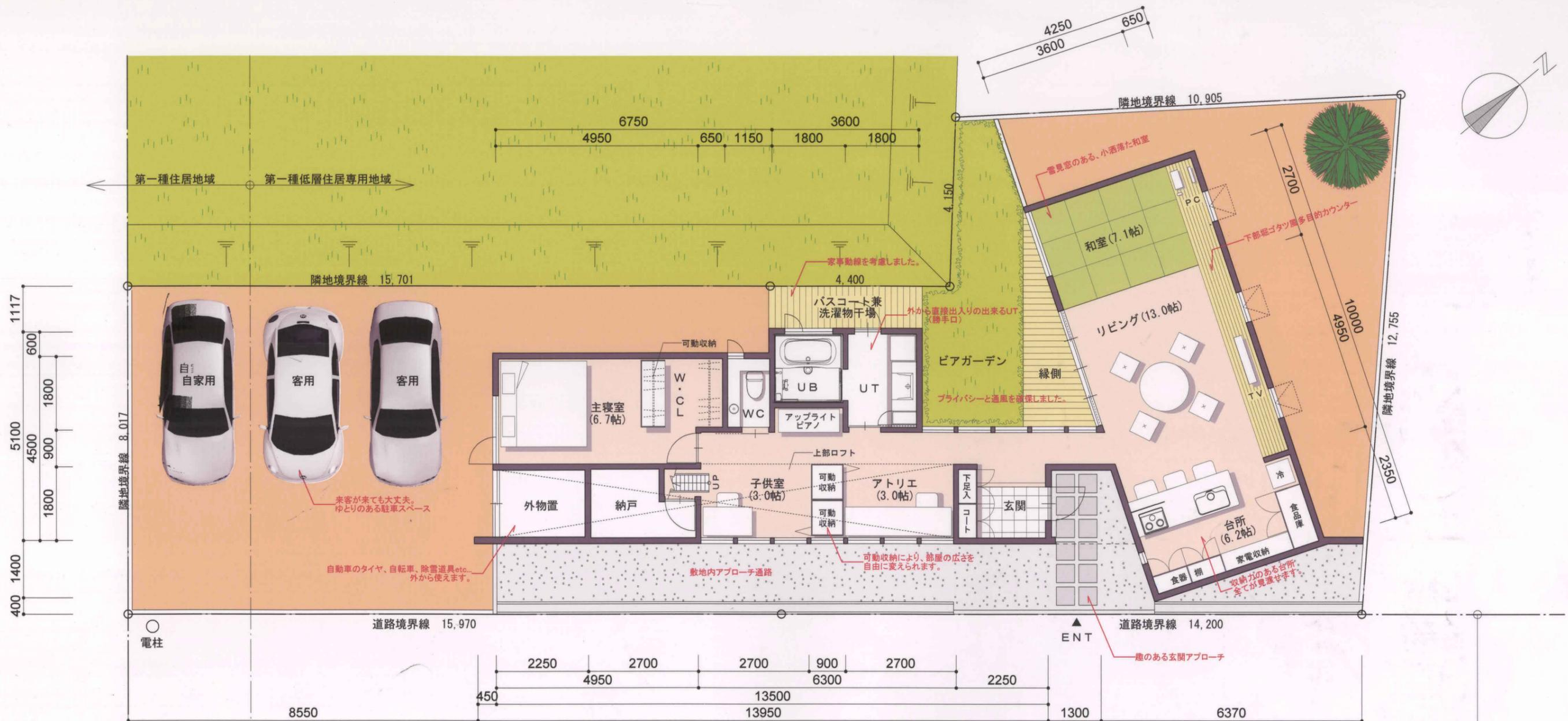
配置図兼1階平面図 S=1:100
