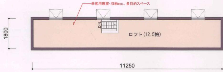
ロフト階平面図 S=1:100
